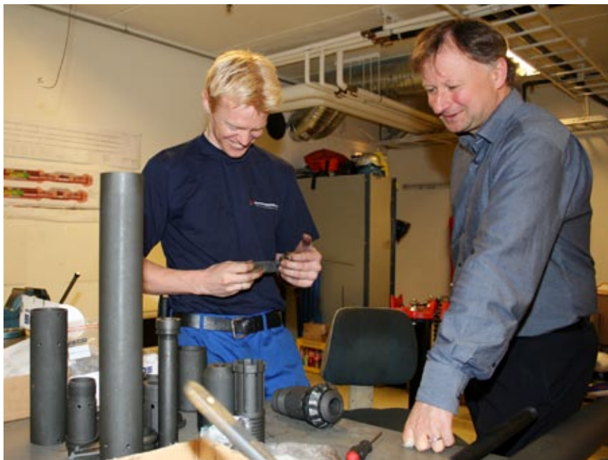
Utviklingen av nye, skreddersydde brønnplugger er nitidig håndarbeid. Her er daglig leder Jan Håbrekke (til høyre) og verkstedleder Christian Malvik i gang med å skru sammen en brønnplugg.
