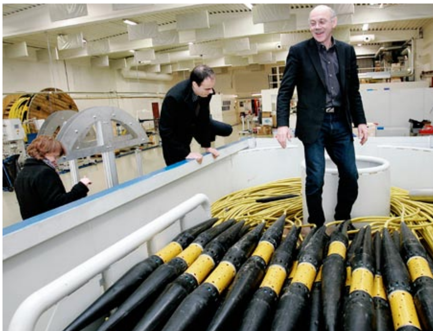
Kablene som graves ned på havbunnen, inneholder fiberoptiske sensorer som gir informasjon om trykk og temperatur i lagene under havbunnen. Optoplan-direktør Morten Eriksrud (til høyre) er spent på pilotinstallasjonene i Nordsjøen. Hilde Nakstad og Torbjørn Heglem har vært sentrale i utviklingen av det nye systemet.
